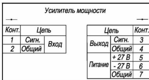
**Рис. 2.11.** Упрощенная электрическая схема усилителя мощности
